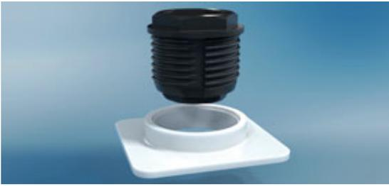
Das abgebildete FLEXITOL® System besitzt das von Böllhoff patentierte K' in K' Gewinde\*. Dieses K' in K' Gewinde zeichnet sich durch spezielle Gewindeprofile aus. Die verschiedenen Systemvarianten sind selbstsichernd, selbstschneidend, selbstformend, verstellbar und toleranzausgleichend und werden direkt in ein Kunststoffbauteil verschraubt. Durch Variation der Einschraubtiefe können bereits Bauteiltoleranzen ausgeglichen werden.
