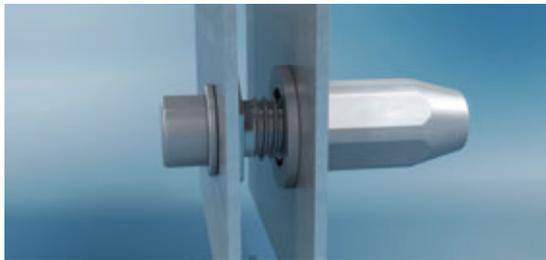
Beim Verschrauben dreht sich das Verstellelement heraus und gleicht den Abstand zwischen den Bauteilen aus. Damit ist die ausgerichtete Position fixiert.
