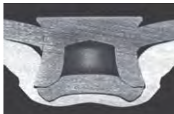
Acero endurecido 1,8 mm Aluminio 2,0 mm
