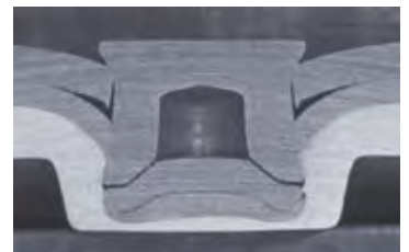
Acero endurecido 1,35 mm Acero de embutición profunda 1,0 mm Aluminio 2,0 mm
