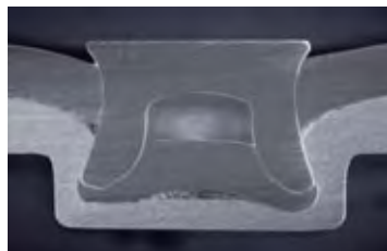
Acero endurecido 1,8 mm Adhesivo Aluminio 2,0 mm
