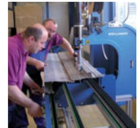
Manueller Einsatz von Stanznietsystemen; hier dargestellt im Tür- und Torbau. Das große Foto zeigt ein handgeführtes Werkzeug mit gyroskopischer Aufhängung.
