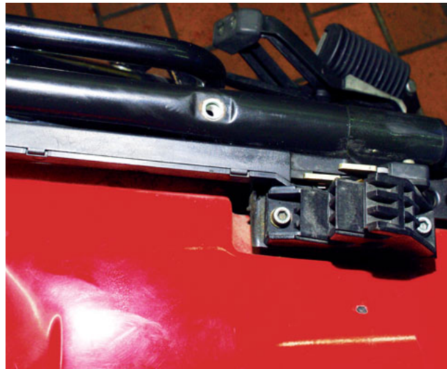
Neu eingebaute RIVKLE® Blindnietmutter zur Befestigung des Gepäckträgers am Motorrad.
