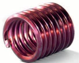
L'HELICOIL® Tangfree Screwlock comporte les mêmes avantages que l'HELICOIL® Tangfree Free Running avec en plus un système de freinage interne qui s'oppose au dévissage de la vis. Ce freinage est obtenu grâce à une ou plusieurs spires polygonales qui provoquent un serrage important sur les flancs du filet. Le couple de serrage et le couple de freinage obtenus avec des filets HELICOIL® Tangfree Screwlock sont conformes aux normes ISO 2320.
