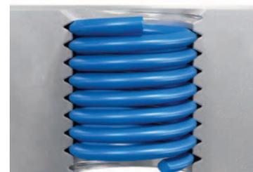
Installation correcte de l'HELICOIL® Smart entre 0,25 et 0,50 pas en-dessous de la surface de la pièce.
