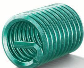
Le filet rapporté est réalisé à partir d'un fil laminé en section losange. On obtient ainsi deux filetages concentriques de haute précision et en l'occurrence un taraudage interne ajustable et utilisable des deux côtés.
