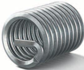
Le filet rapporté est réalisé à partir d'un fil laminé en section losange. On obtient ainsi deux filetages concentriques de haute précision et en l'occurrence un taraudage interne ajustable et utilisable des deux côtés. Le taraudage ISO obtenu correspond à la classe de tolérance DIN 13 6H ; pour des exigences particulières, un taraudage de classe 4H peut être obtenu.
