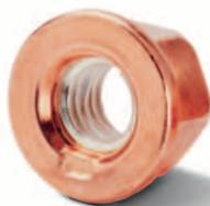
L'écrou frein haute performance HELICOIL® se compose d'un corps d'écrou assemblé avec un filet rapporté HELICOIL® Plus Screwlock. La fonction anti-dévissage est assurée par la ou les spires déformées de l'HELICOIL®. Ces spires vont se déformer de façon élastique et réversible au moment du vissage. Le couple de freinage ainsi obtenu est conforme aux exigences de la norme ISO 2320. La gamme est disponible dans différents matériaux. Voir brochure HELICOIL® écrou frein.
