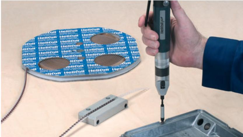
Einbau des HELICOIL® Plus
