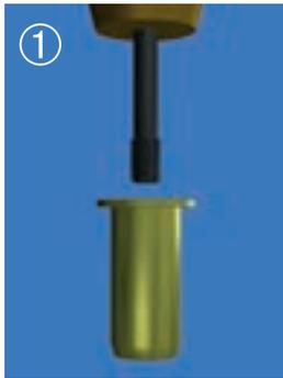
① Avvitamento del rivetto filettato
