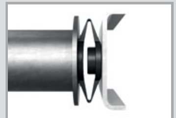
a) Positionieren der Bauteile b) Axialer Toleranzausgleich durch Stauchen des FLEXITOL® Eco
