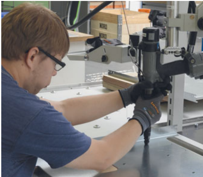
Einbau von RIVKLE® Blindnietmuttern an dünnwandigen Bauteilen für Windkraftanlagen.
