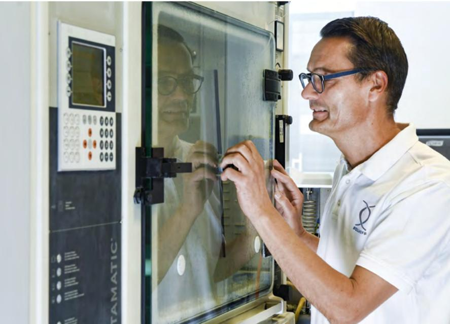
**Salzsprühnebel-Prüfkammer zur Korrosionsprüfung von metallischen Werkstoffen und Schutzüberzügen gemäß DIN EN ISO 9227 und DIN EN 60068-2-11**
