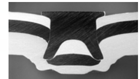
EN AW-5754, t=1,0 mm DP1000, t=1,5 mm Al-Druckguss, t=2,7 mm HDZ 5,5x7 SK H4 Almac
