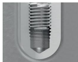
Sacklochbohrung für HELICOIL® mit Zapfen gemäß DIN 76 Teil 1 (Regelfall)
