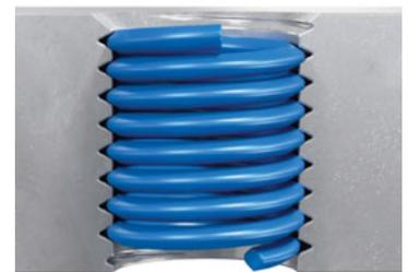
HELICOIL® Smart korrekt montiert ( $0,25 - 0,5 \times P$  unter die Bauteiloberfläche)
