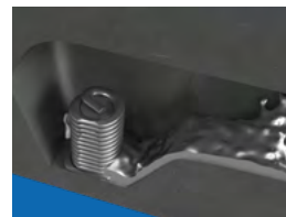
Eingießen der flüssigen Aluminiumschmelze in die Füllkammer ohne Druck mittels Dosierautomaten oder von Hand mittels eines Schöpflöffels.
