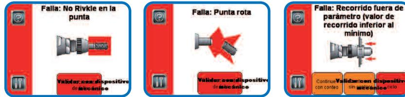
El suministro de aire se corta cuando se produce un fallo; el usuario debe confirmarlo a través de la pantalla, contando o no la parte.
