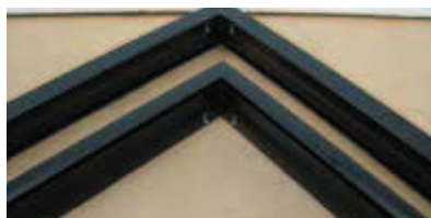
Pinching en marcos de aluminio de colectores solares
