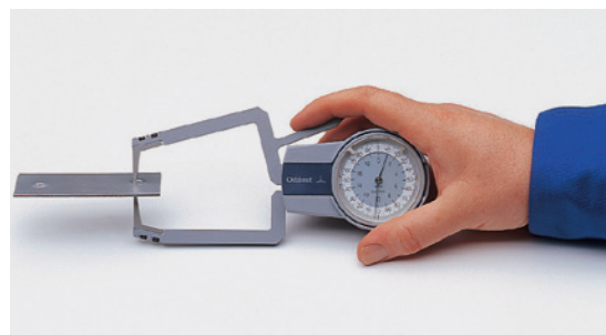
Badanie grubości materiału w miejscu przetłoczenia (ST)
