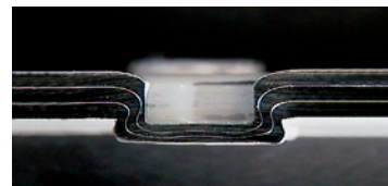
C Stal 0,7 mm Warstwa przylepna 2 x stal 0,7 mm
