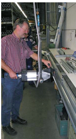
Narzędzie ręczne 0706 IP z zawieszeniem żyroskopowym na linii produkcji stolarki drzwiowej okiennej
