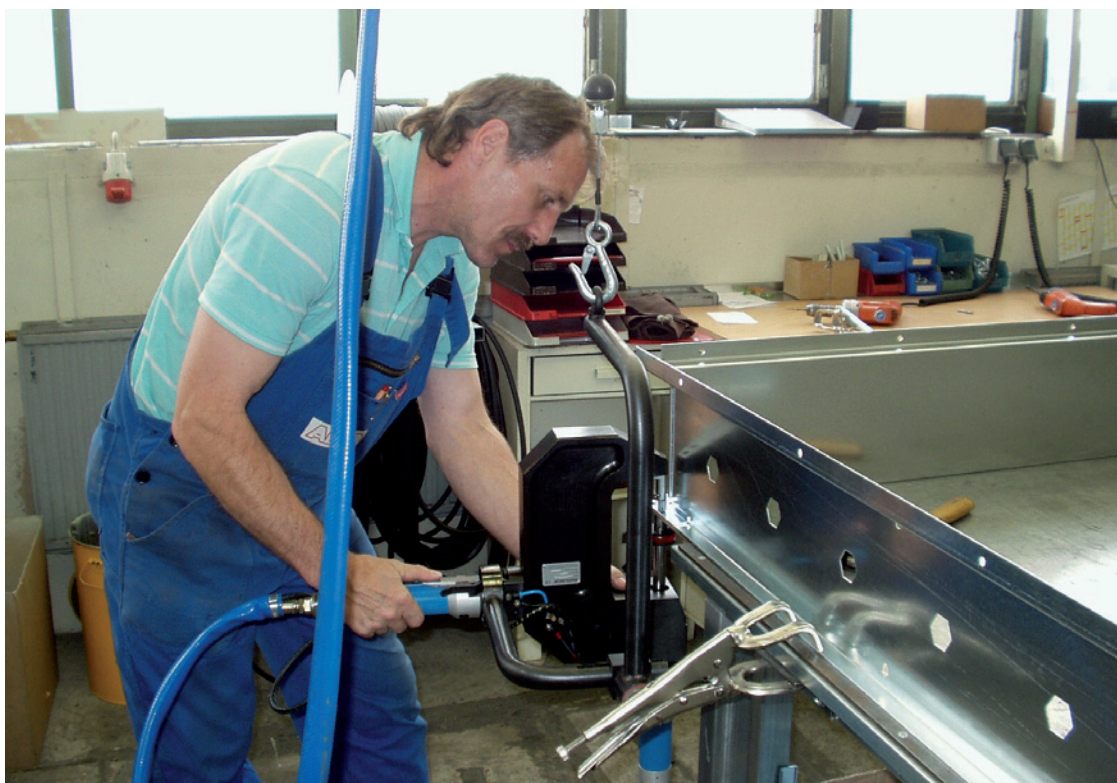
Narzędzie ręczne 0706 IP z zawieszeniem żyroskopowym na linii produkcji stolarki drzwiowej okiennej
