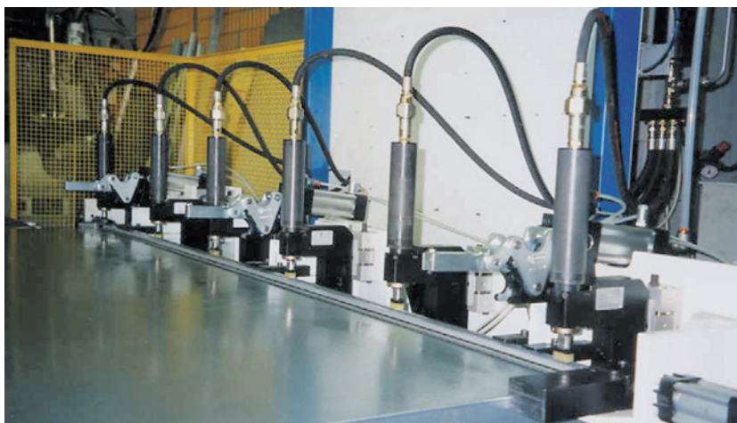
Systemy półautomatyczne mogą służyć do łączenia elementów wielkogabarytowych używanych w energetyce oraz branży HVAC (i podobnych do tu zilustrowanych)
