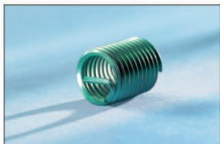
Резьбовые вставки HELICOIL® plus обеспечивают высокопрочную, износостойкую, устойчивую к термической нагрузке резьбу, в том числе в материалах с низкой прочностью (алюминий, чугун, магниевые сплавы и др.).
