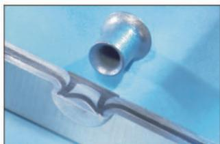
RIVSET® - технология создания высокопрочного соединения однородных и комбинированных материалов, с помощью самопроникающих заклёлок, без предварительного создания отверстия в деталях.
