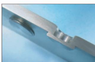
RIVCLINCH® - соединение металлических листов друг с другом посредством холодной штамповки материала с образованием геометрического замыкания.
