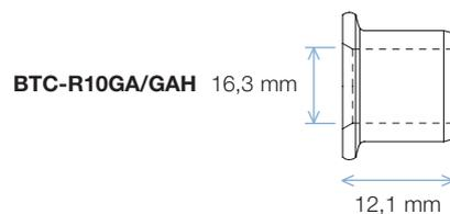
**d1** = Diamètre - **l** = Longueur de la tige - = Épaisseur à sertir (min-max) - **Ø** = Dimension du trou
