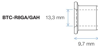
$d_1$  = Diamètre -  $l$  = Longueur de la tige -  $\begin{matrix} \downarrow \\ \text{---} \\ \uparrow \end{matrix}$  = Épaisseur à sertir (min-max) -  $\varnothing$  = Dimension du trou
