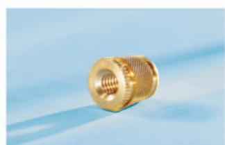
AMTEC® - высокоточные резьбовые вставки для установки в детали из термопластичных или термореактивных пластмасс путем термической запрессовки, ультразвуковой вварки, самонарезающего ввинчивания или анкеровки распирианием.
