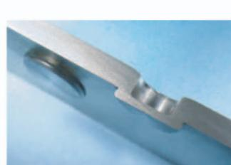
RIVCLINCH® - соединение металлических листов друг с другом посредством холодной штамповки материала с образованием геометрического замыкания.
