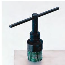
**Установка вставки HELICOIL® plus с патроном предварительного натяжения**
