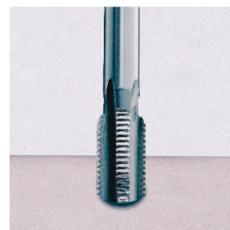
**3) Установка вставки HELICOIL® plus без патрона предварительного натяжения**
