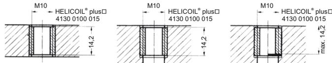
Резьбовая вставка HELICOIL® plus с болтом в установленном состоянии
