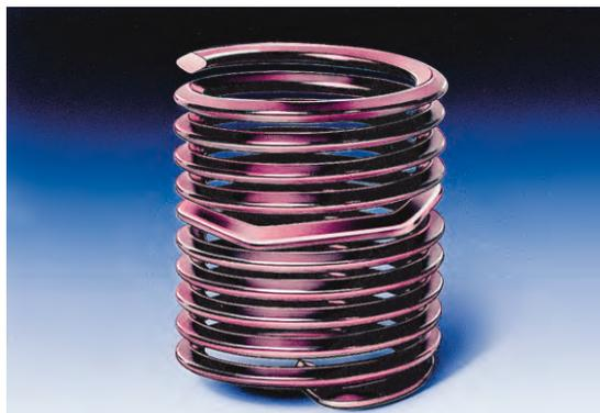
Резьбовые вставки HELICOIL® plus screwlock красного цвета должны использоваться только с болтами более высокого класса прочности (начиная с 8.8). Для болтов из высоколегированной стали необходимо использовать смазочные материалы в соответствии с рекомендациями производителей. Для HELICOIL® plus screwlock применяются точно такие же значения затяжки и моменты вращения, что и для резьбовых вставок HELICOIL® plus free running.
