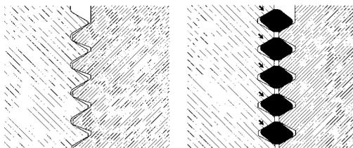
Оптимальное распределение усилия предварительного натяжения повышает усталостную прочность динамически нагружаемых болтов. По этой причине HELICOIL® также можно использовать для резьб в высокопрочных материалах, например, стали или чугуновых сплавах.
