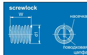
W и d<sub>1</sub> - контрольные параметры неустановленной резьбовой вставки HELICOIL® free running и HELICOIL® screwlock.
