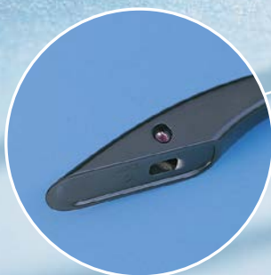
Okucie relingu dachowego samochodu osobowego. Odlew aluminiowy z HELICOIL® plus M 6 x 6 SCREWLOCK®
