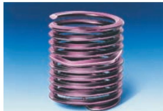
I filetti riportati HELICOIL®plus SCREWLOCK®, riconoscibili dal loro colore rosso e dalla punzonatura a forma di diamante, debbono essere utilizzati esclusivamente con viti di classe uguale o superiore alla qualità 8.8.
