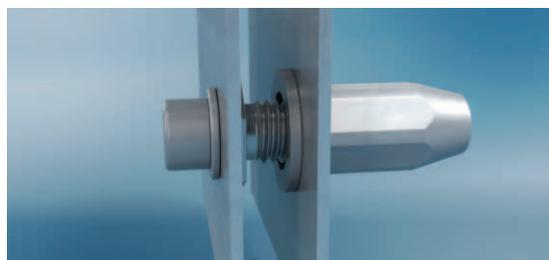
Lors du vissage, la douille de rattrapage de jeu se dévisse et compense l'écart entre les composants. La position est donc fixée entre les deux supports.
