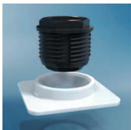
Le système FLEXITOL® (voir figures) est fourni avec le filetage\* Böllhoff K' in K' , breveté. Ce filetage K' in K' se caractérise par un profil de filetage unique. Les différentes variantes du système sont autobloquantes, autotaraudeuses. Les pièces en plastique sont directement vissées dans le logement du support en plastique. Les tolérances des composants peuvent être compensées en faisant varier la profondeur de vissage.
