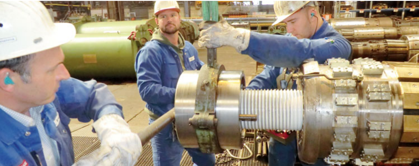
Der HELICOIL® Gewindeeinsatz wird aufgeschraubt
