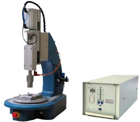
Machine de pose par ultrasons avec une fréquence de fonctionnement de 35kHz permettant de riveter, de souder ou d'assembler des inserts UNITEC K' in K' ("plastic in plastic")
