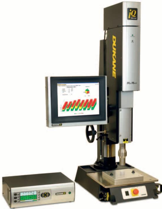
Machine de pose par ultrasons avec une fréquence de fonctionnement de 20kHz permettant de riveter, de souder ou d'assembler des inserts UNITEC® K' in K' ("plastic in plastic"). Elle permet de contrôler tous les paramètres et de les transmettre vers un système d'acquisition de données de production
