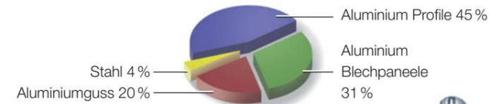
Ein High-Performance Car in Aluminium-Space-Frame-Bauweise, wobei im Bereich der A-Säule und des Daches Stahlteile zum Einsatz kommen.
