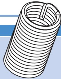
Überall dort, wo Werkstoffe geringer Scherfestigkeit (z.B. Aluminium, Alu-Magnesium-Legierungen und faserverstärkte Kunststoffe) eingesetzt werden, ist HELICOIL® plus zur Gewindepanzerung unverzichtbar.
