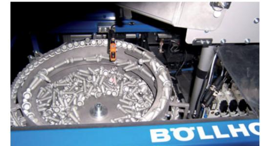
Die Entscheidung Schraubgeräte mit automatischer Zuführung in der Produktion einzusetzen, begründet sich in der Wirtschaftlichkeit des gesamten Prozesses.
