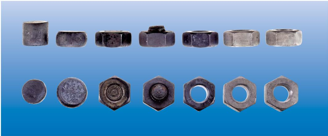
Umformstufen einer Sechskantmutter
