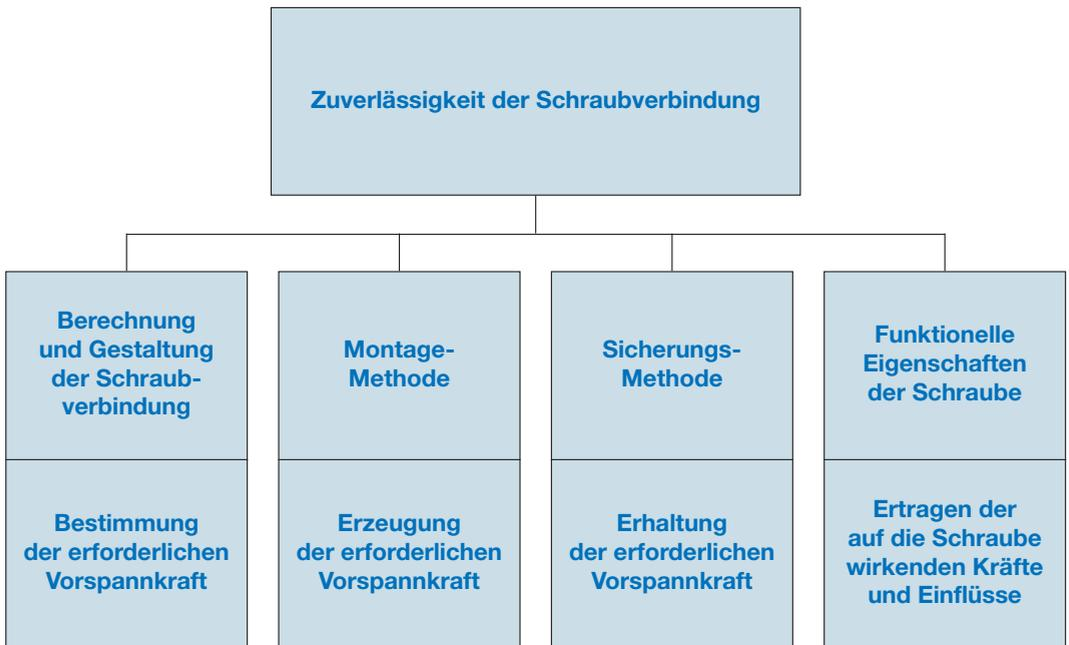
Aus Merkblatt 302\*): Eine gut ausgelegte und kontrolliert angezogene Schraubverbindung benötigt in der Regel keine zusätzliche Schraubensicherung!
