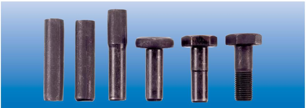
*Umformstufen einer Sechskantschraube*
