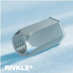
Am Türaggregateträger werden ganz unterschiedliche Bauteile befestigt – darunter auch das Lautsprechersystem. Um dieses auch an einem Türaggregateträger aus Aluminium zu befestigen, werden RIVKLE® Blindnietmutter mit 6KT aus Stahl – offene Ausführung – eingesetzt. Diese Verbindungslösung schafft auch an einem dünnwandigen Werkstück ein belastbares Mutterngewinde.
