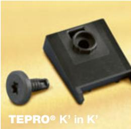
Das Verschraubungsprinzip Kunststoff in Kunststoff (K' in K') ist eine Böllhoff eigene Innovation. Bei diesen Verbindungen ist die Gewindegeometrie von ausschlaggebender Bedeutung, da sich die K' in K' Gewinde in die zylindrisch vorgefertigten Bohrungen ein „Aufnahmegewinde“ formen bzw. schneiden müssen.
