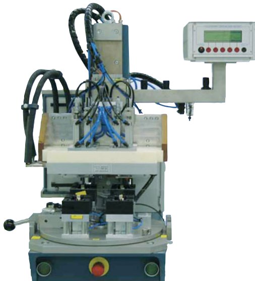
EWS-Warmeinbaumaschine zum Einbetten von acht HITCERT® Gewindeeinsätzen M 1,6 in zwei Handyhalbschalen
