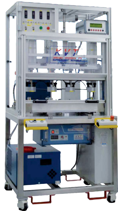
EWS-Warmeinbaumaschine zum Einbetten von vier HITCERT® Gewindeeinsätzen in eine Kofferraumgriffleiste
