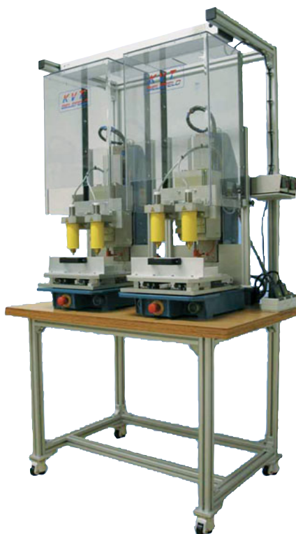
Warmeinbaumaschine KVT Basic 5000 DUO zum gleichzeitigen Warmeinbetten von vier HITSERT® Gewindeeinsätzen in zwei PKW-Außenspiegelveinkleidungen
